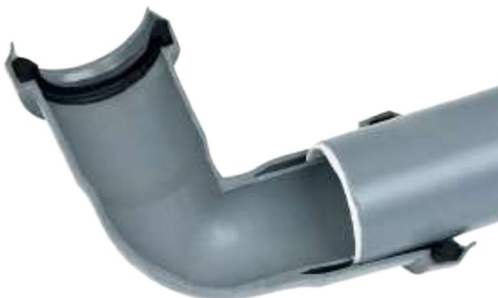
I raccordi della “**LINEA DOPPIO INNESTO**” sono brevettati. Il brevetto consiste nell’applicazione di un’anima interna al bicchiere di uscita che va ad inserirsi all’interno del tubo, creando così una doppia sicurezza.
