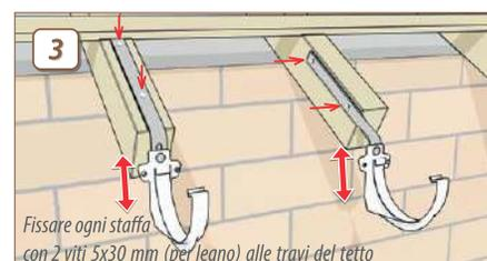
3. Per installare il sistema sulle travi, usare le staffe piatte o laterali. Usare viti e dadi M6x16 per fissare le cicogne, in modo da regolare facilmente la gronda con l'inclinazione necessaria.
