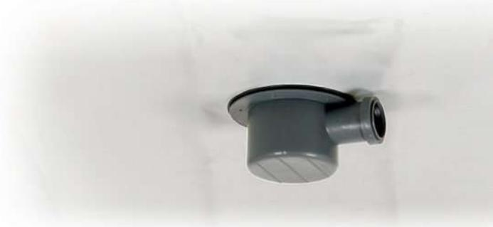
Dopo aver montato il pozzetto con lo scarico nella direzione desiderata, il muratore provvederà alla preparazione del sottofondo. Finito questo è possibile applicare la lastra con la flangia pre-saldata sul pozzetto senza ulteriori operazioni. Questo permette di poter posizionare come si vuole la lastra flessibile quadrata, indipendentemente da dove punti lo scarico. La tenuta idraulica tra lastra e pozzetto è garantita dalla guarnizione ad espansione del tappo grigliato.
